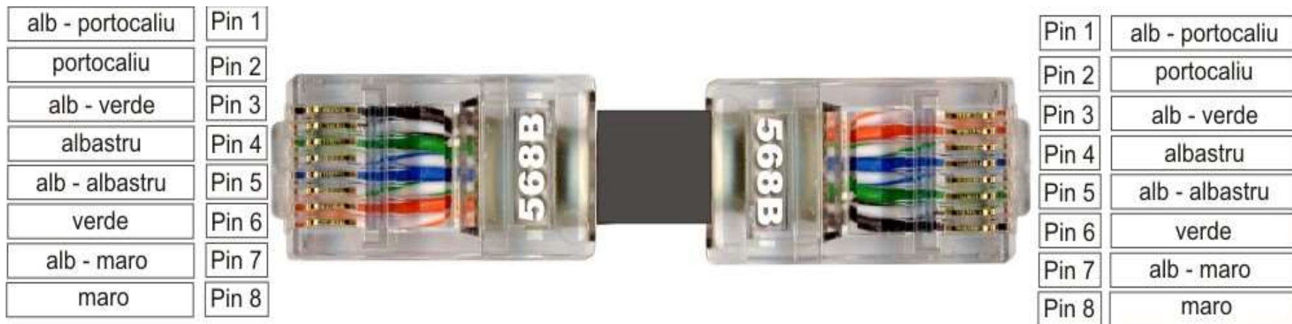
Fig. 8.1 Ordinea firelor într-un cablu Straight-Through (cablu direct)
