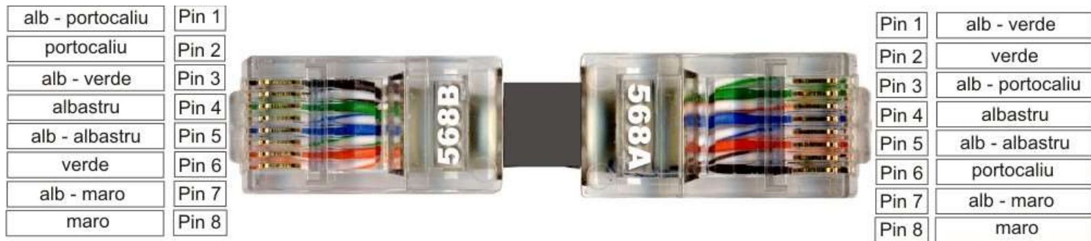
Fig. 8.2 Ordinea firelor într-un cablu Cross-Over (cablu inversor)
