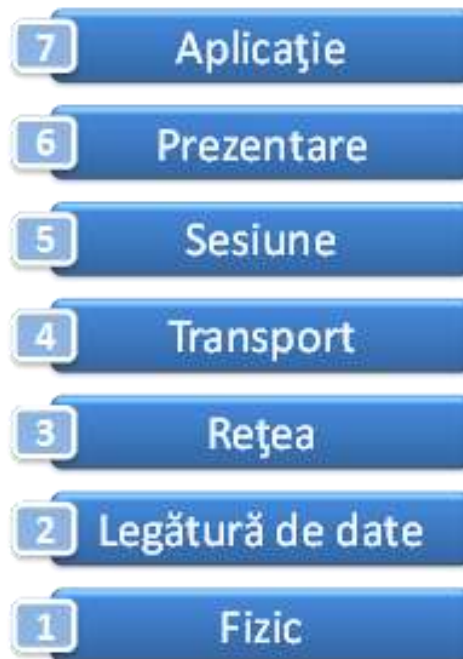
Fig.2. Nivelele modelului OSI
