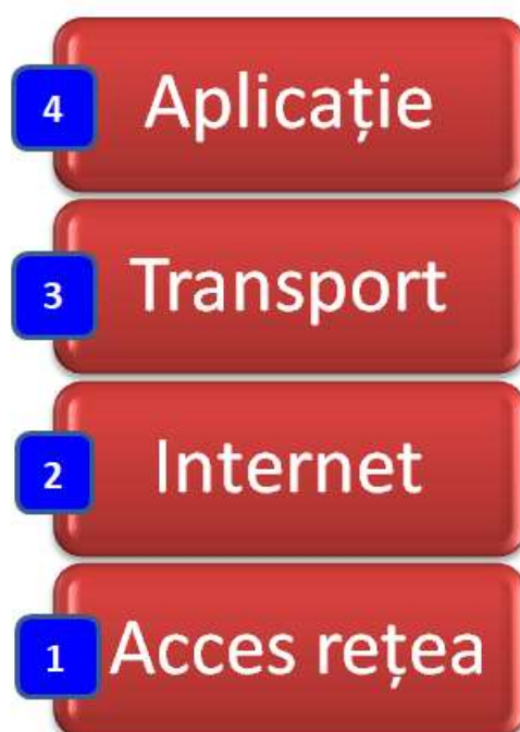
Fig.3. Nivelele modelului TCP/IP
