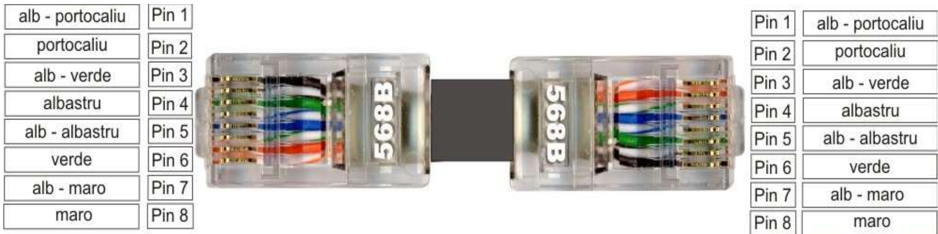
Fig. 8.1 Ordinea firelor într-un cablu Straight-Through (cablu direct)
