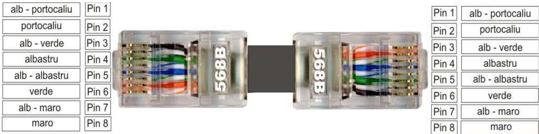
Fig. 8.1 Ordinea firelor într-un cablu Straight-Through (cablu direct)
