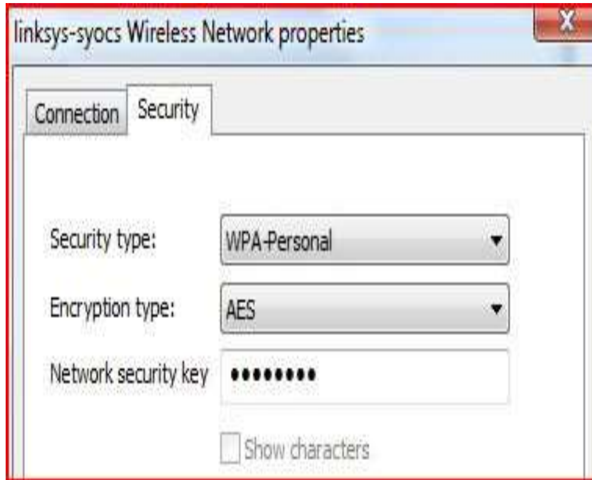
Fig. 7.6 Panou de informații care afișează modul de securitate și tipul criptării a unui
